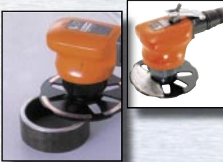
Beveller – Kantfres for grading av mindre deler, eller hull i plater. Jobber med skråstilt vendeskjær på roterende spindel, med justerbart distansestykke mot del som blir gradet.
