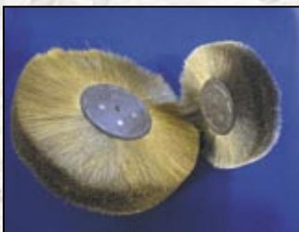
Kradsebørster med hull for konspindel. Normalt Ø 80 - 250 mm. Tråd: 0,06 til 0,30 mm inox, stål, messing, nysølv.
