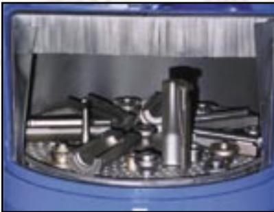
kontinuerlig gjennom maskinen. Dette er en meget effektiv metode for rensing og/eller avgrading, og den benyttes ofte ved støperier og andre bedrifter med stor produktgjennomgang. Metoden er lite arbeidsintensiv.
