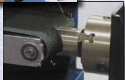
Rørendesliper. Formsliping av runde eller firkantrørender, diameter 18,5-150 mm. Gradtall forhåndsinnstilles 0 - 75 grader.
